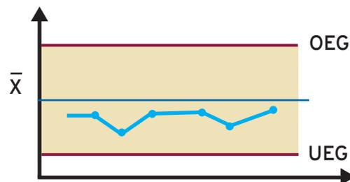
Abbildung 2: Qualitätsregelkarte mit einem Run im Werteverlauf (nach[Linß05])
